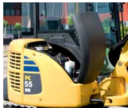
Cofano anteriore: accesso al serbatoio carburante
