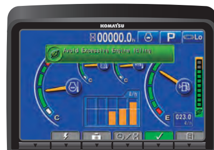
Indicatore Eco regolabile e avviso di motore al minimo
