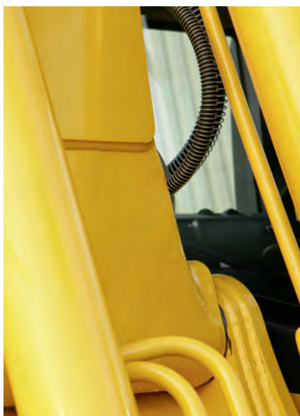
Base del braccio in fusione d'acciaio
