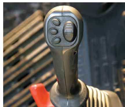
Manipolatori con comando proporzionale per gli accessori di serie
